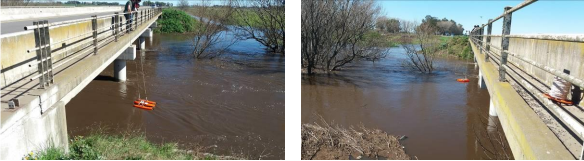
Figura 8. Aforo con catamarán ADCP en RNNº 226 y arroyo del Azul.
